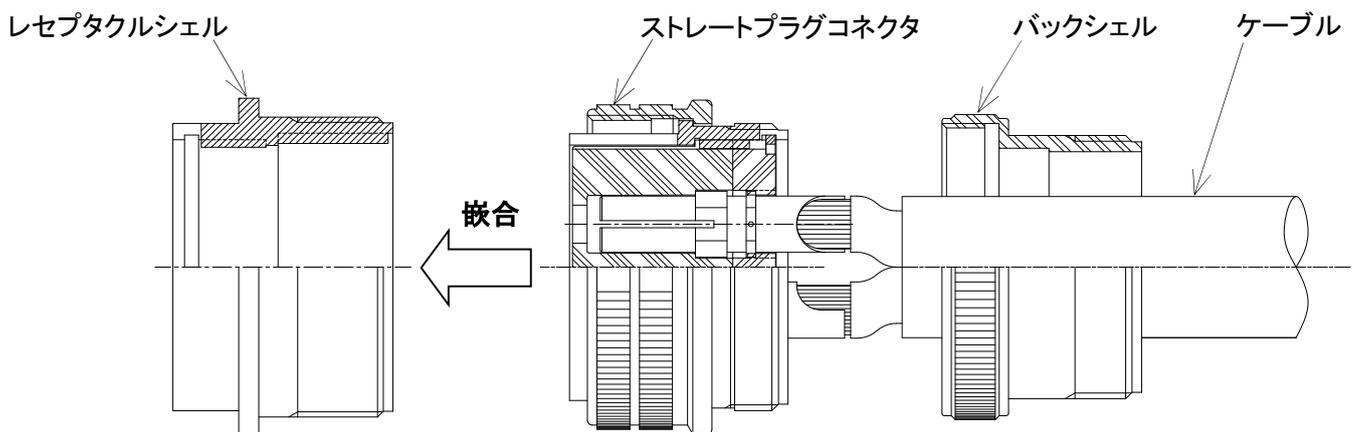
5-11. バックシェルにケーブルクランプボディを締め付けます。
